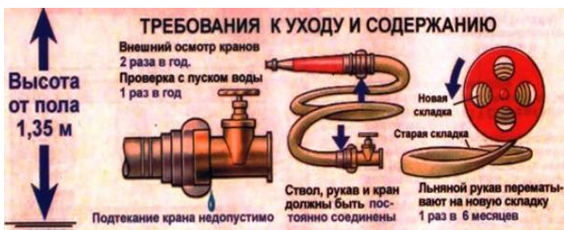
Рисунок 4 – Требования к уходу и содержанию внутреннего пожарного крана
